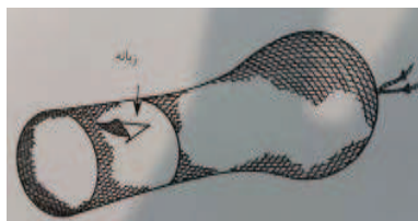
شکل ۶- زبانه یا معبر فرار ماهی و محل نصب آن بر روی تور ترال.
